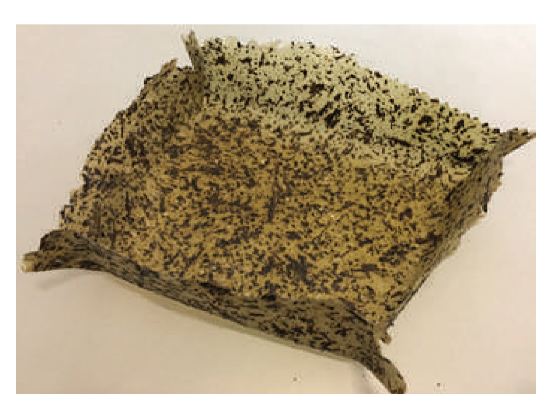
Figura 9. Modelado de bioplástico de eucalipto.
